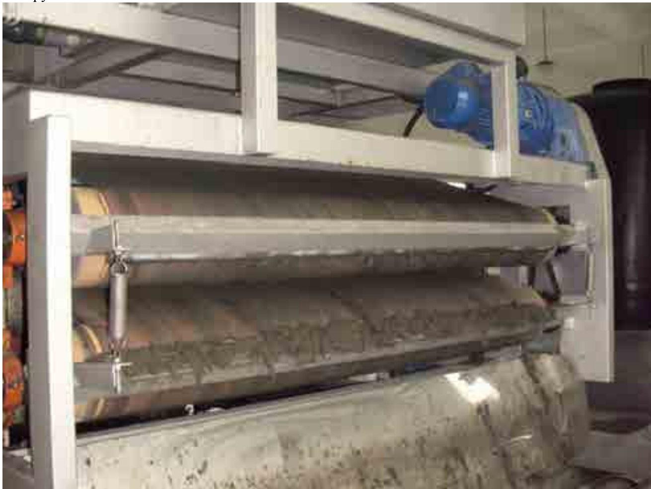
Рис.32. Скребок для снятия отфильтрованного кека.
