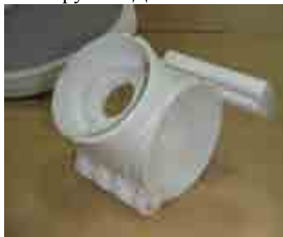
Рис.15. Крепление при помощи муфты.
