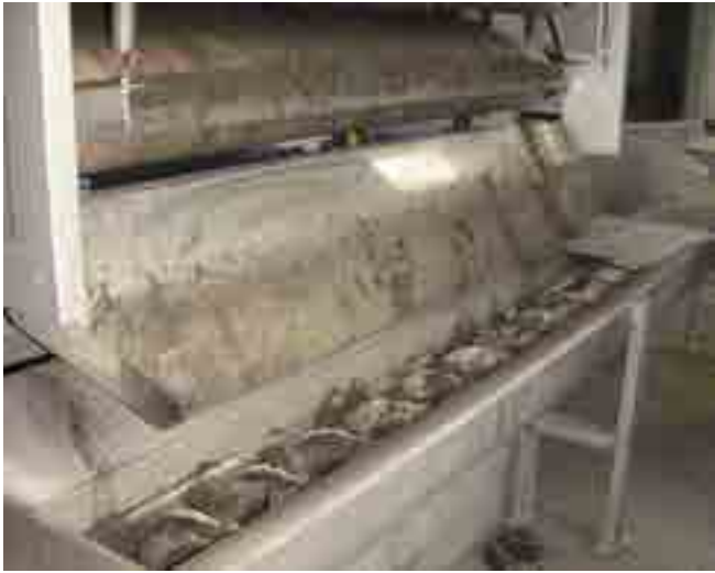
Рис.33. Направляющее устройство выгрузки кека и отправка кека на шнековый конвейер.
