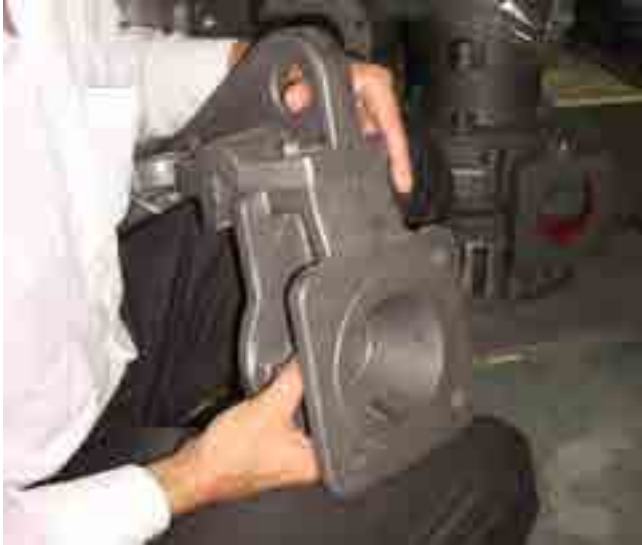
Рис.24. Сопло эжектора в виде единой чугунной детали с крюком разъемного соединения насоса.
