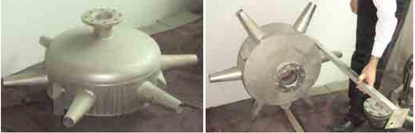
Рис. 26. Струйный аэратор JET.
